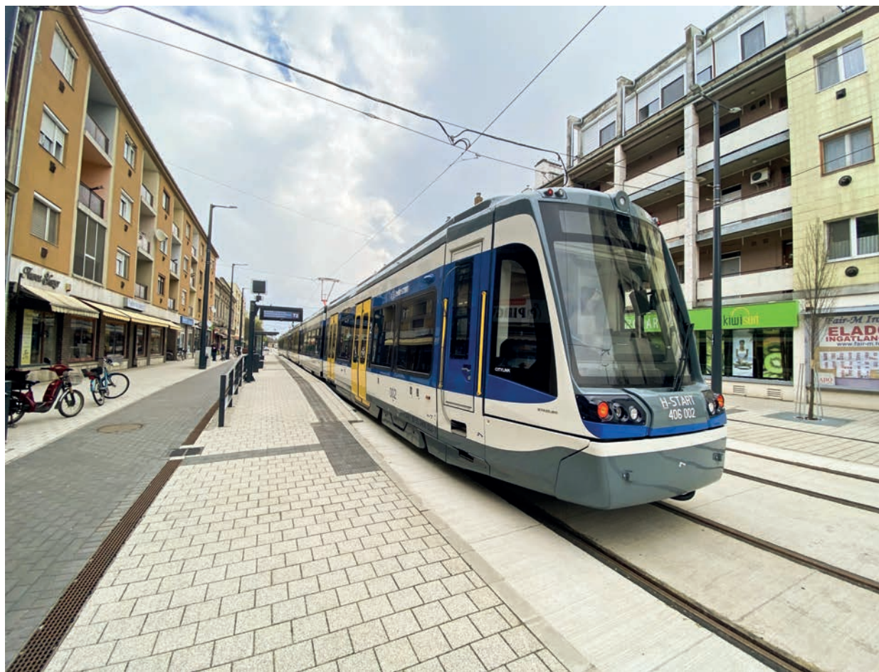
A HÉT ELSŐ NAPJAIBAN MÁR A 2-ES SZÁMÚ TRAM-TRAIN SZERELVÉNY IS MEGKEZDTE VÁSÁRHELYI MENETPRÓBÁIT. TÖBBSZÖR IS ÖSSZEKAPCSOLVA FUTOTT A 2 VASÚT-VILLAMOS, AMELY EGYÜTTESEN 74 MÉTER HOSSZÚ, ÍGY IGAZÁN IMPOZÁNS LÁTVÁNYT NYÚJTOTT. ÁPRILIS 13-ÁN EGYÉBKÉNT MEGÉRKEZETT A 3. JÁRMŰ IS A SZENTESI MOTORGARÁZSBA.
